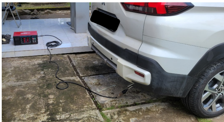
Gambar 2. Proses analisis Emisi Gas Buang menggunakan Gas Analyzer QRO-402
