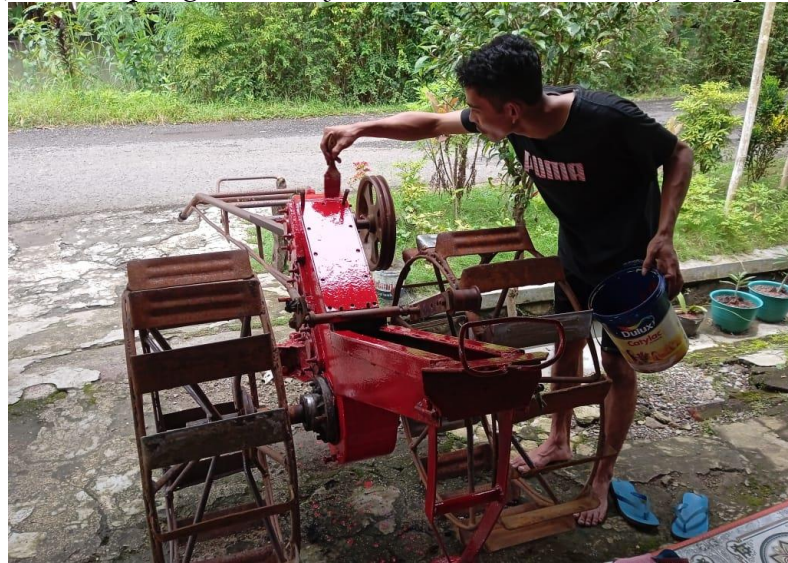
Gambar 7. Proses Pengecatan Body dan Chasis Traktor
