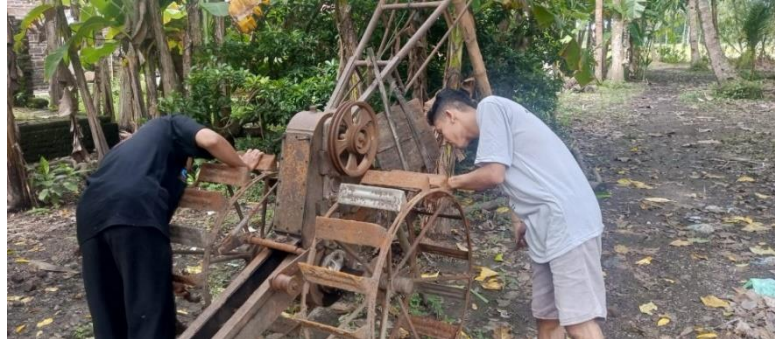
Gambar 5. Proses Pengamplasan Body dan Chasis Traktor
